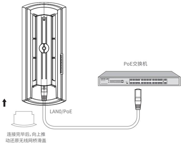
标准PoE供电：网桥LAN0口与PoE交换机相连，PoE交换机同时给网桥和支持PoE供电摄像头等终端设备供电。
