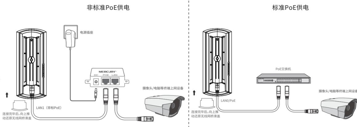
3 请按图示方向（网口端向下）安装网桥，将网桥放在选定的位置上，调整正面朝向使其与选定的方向大致相同。
